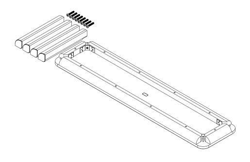
X8 - M8 TIMBER SCREW X1 - M4 ALLEN KEY
